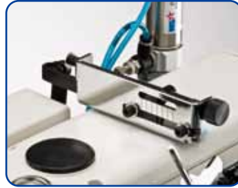
精密刻度設計，能快速且精準調整上送差動速率。
