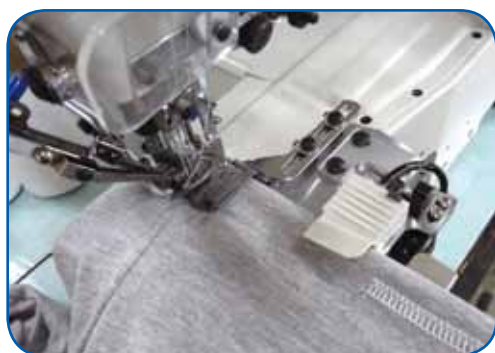
自動摺下擺車縫樣式 Stitch sample of bottom hemming
